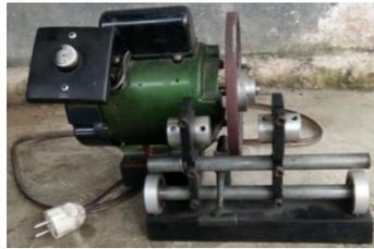
Gambar 3 Mesin poles serba guna (modifikasi *camshaft*/noken as)
