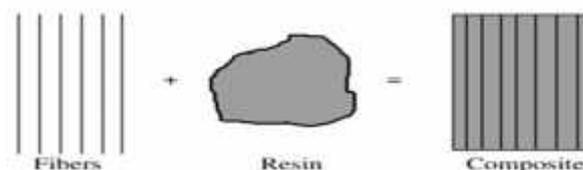
Gambar 1. Pembentukan material komposit menggunakan serat dan resin (Mazumdar, 2001)
