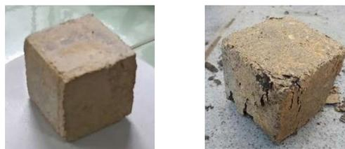
**Gambar 5.** Kondisi benda uji sebelum dan sesudah pengujian kuat tekan
