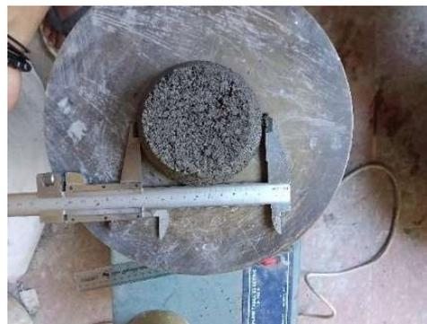
**Gambar 4.** Pengujian Sifat Leleh Mortar Segar
